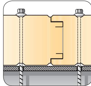
Grazie alla perfetta configurazione del giunto, oltre a rendere piacevole ed uniforme la superficie dell'involucro edile, il pannello Isolpack è in grado di abbattere considerevolmente i ponti termici che, come è noto, sono causa di dispersione energetica e formazione di condensa.
